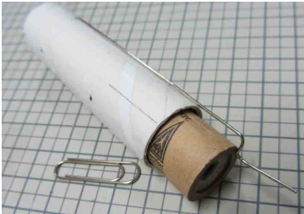
図4 上：板バネの形状 下：ゼムクリップから作ったバネ
