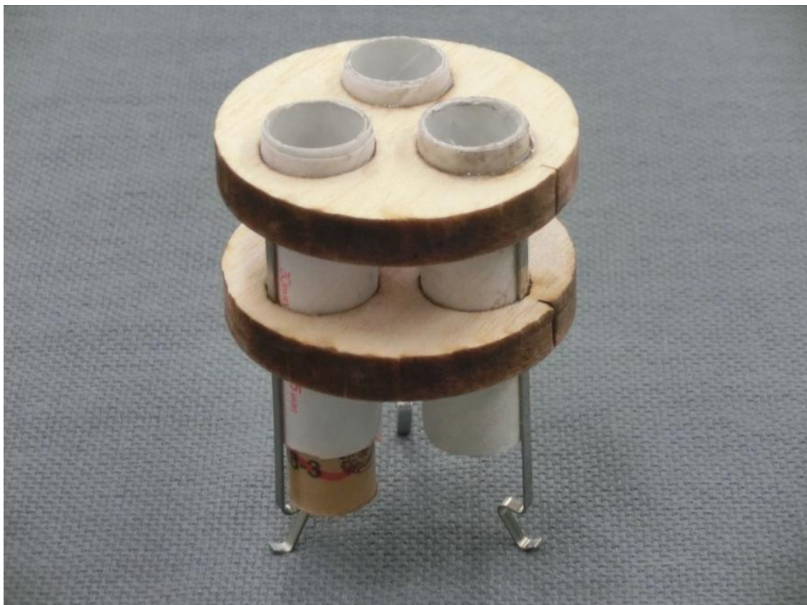
図7 エンジンマウントの構造
