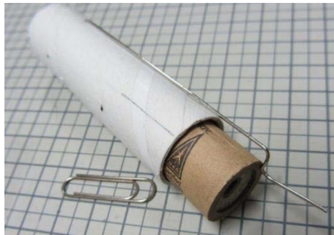
図 3 上：板バネの形状 右：ゼムクリップから 作ったバネ
