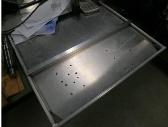
図 17 天板にリブを入れた様子
