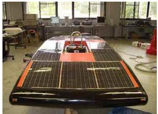
図11 パネル取り付け完了
