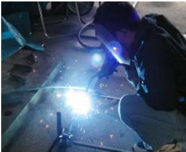
8m 電波望遠鏡のピース面製作のために溶接をしているところ
