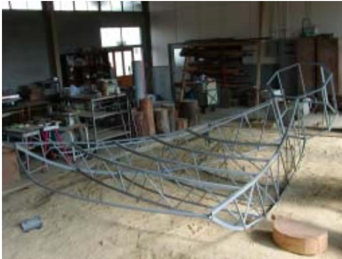
8m 電波望遠鏡の土台 1/8 ピース部分
