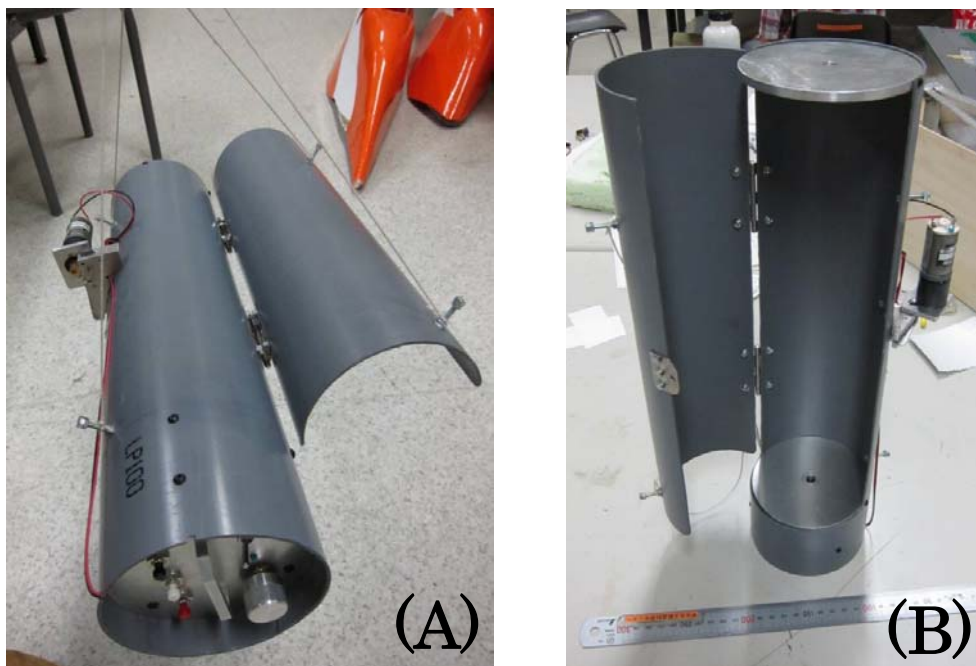
図3. 落下装置外観。(A) 落下装置の外側、(B) 落下装置の内側。缶サットを落下装置の中に収納し、バルーンに吊り下げる。タイマーが作動して落下装置の扉が開き、中の缶サットが落下するという仕組み。
