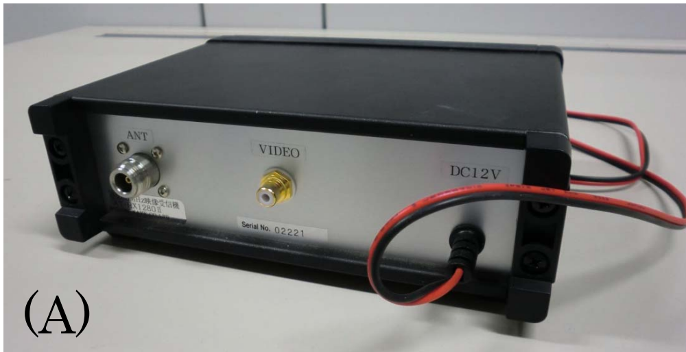
図 8. (A) 映像受信機 (コスモウェーブ社製)。DC 12V で作動するよう設計されている。(B) 1280 MHz 映像送信機 (コスモウェーブ社製)。1.2 GHz 帯のアマチュアバンドでリアルタイム動画を送信することができる。
