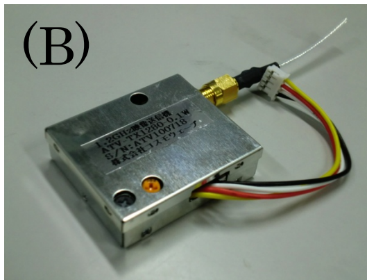
図 8. (A) 映像受信機 (コスモウェーブ社製)。DC 12V で作動するよう設計されている。(B) 1280 MHz 映像送信機 (コスモウェーブ社製)。1.2 GHz 帯のアマチュアバンドでリアルタイム動画を送信することができる。
