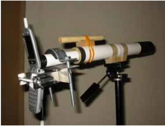
コルキットスピカ 4cm 屈折望遠鏡 (手製の小型望遠鏡)
