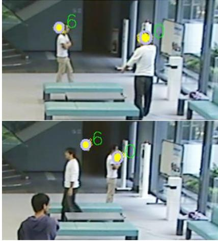
図 4: 多視点パーティクルフィルタを実環境下に 応用した例
