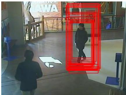
図 7: 新しい特徴と Real AdaBoost を用いた特徴による人物検出
