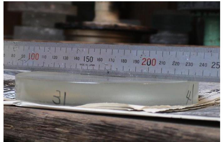
図 3 鏡材の凹み具合の測定
