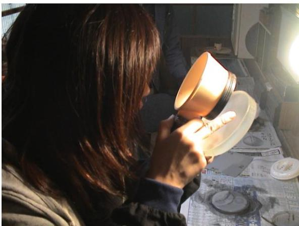
図 4 鏡材が磨けているかの確認
