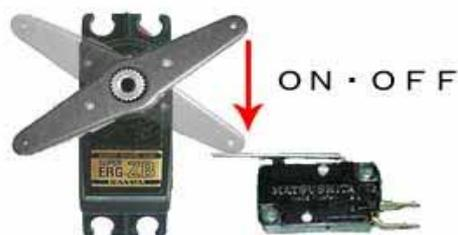
図 8 サーボによるスイッチ動作
