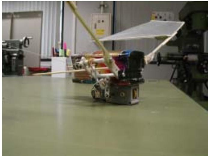
図16. クランク機構を用いた翼の機構
