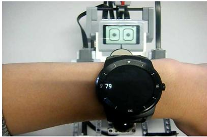
ロボットが人の状況を動きと表情で示し、相手に伝えます。ロボットをなげると喜んで回転動作したりします。心拍が上がるとロボットが騒ぎ出します。
