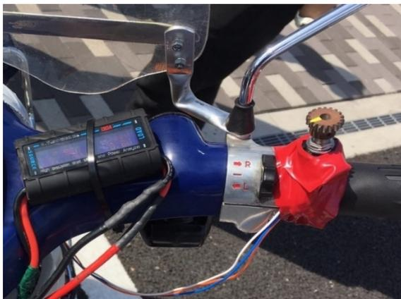
図6. 可変抵抗器を用いたスロットル
