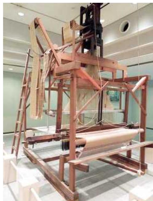
2階に上がると、まず目に飛び込んでくるのが、ロビーに鎮座するこの「ジャカード織機」。明治44（1911）年頃から大正末期まで、柄毛布を織るのに使われていた手織機。「三丁杼変換装置とジャカードにより、緯糸と経糸の操作で自由に柄を出すことができる」というシロモノです。織機の上方にセットされたパンチカードのパターンによって、複雑な模様を織ることができたのだそうです。
