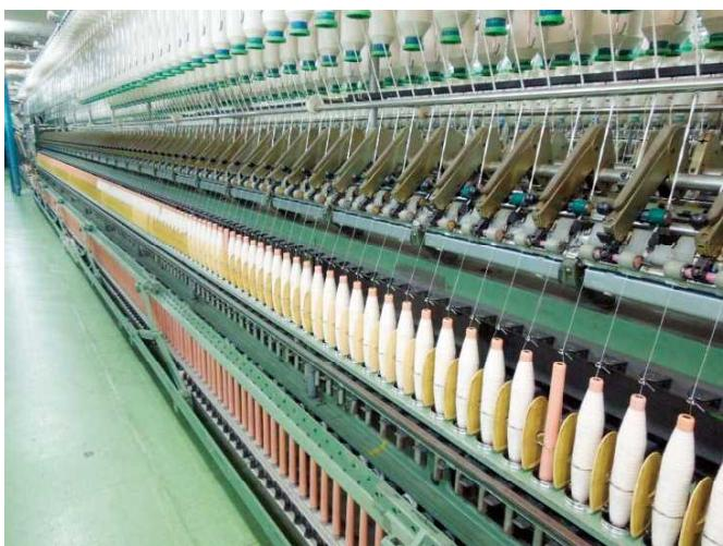
原料を、ときにはブレンドもして、引き揃えて束にしてスライバーというものを作り、このスライバーをさらに引き伸ばし撚りをかけて粗糸にしていきます。そして、精紡機で粗糸を引き伸ばして撚りをかけることで、細くて丈夫な糸が出来上がっていきます。
