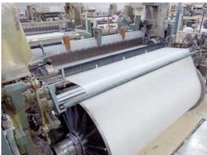
2日目に訪れた木下織物の織機は小幅織物を織るシャトル（有杼）織機でしたが、こちらは広幅織物を織るエアジェット（圧縮空気の噴射力をを利用して緯糸を入れる）織機。工場の1階には、こうした織機数十台がずらりと並んで稼動しています。
