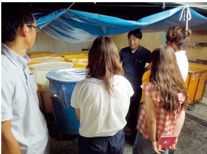
染色の前にタオル生地ついている糊（のり）を除去します。このとき、短時間で済む化学薬品の使用を避け、時間はかかるものの環境に配慮した酵素を使った糊の分解除去が行われています。
