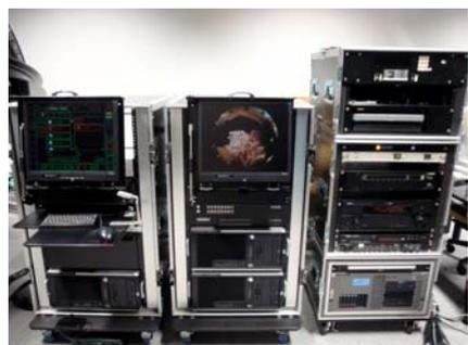
図2 投影システム（左からメインコンピュータ、描画コンピュータ、音響システム）
