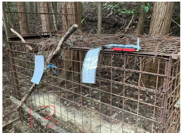
図 7 笠置町鹿畏検知センサ
