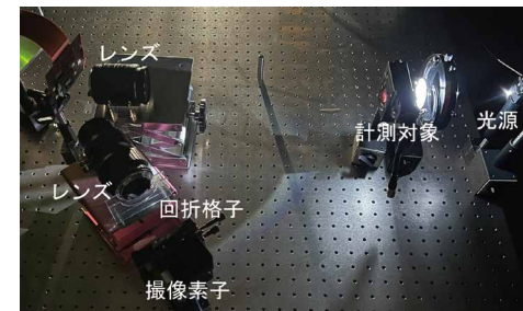
図3. 回折格子を利用した分光イメージング光学系
