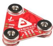
筋肉の収縮によって発生した筋繊維間の電位を取得し、アナログ信号として出力
