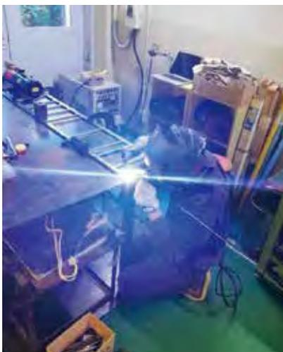
図6 車体溶接の様子
