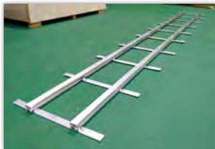
レールと枕木の接合には、交流TIG溶接を使用し、約200mmおきに隅肉溶接を用いて接合。
