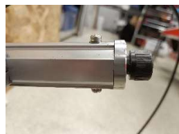
図 2-10 加工後（上下ビス止め、アルミ部品に置換）
