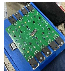
図 4：設計した MOSFET 基板 (左)
