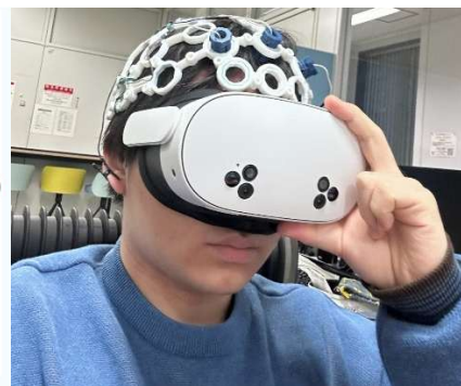
図 2：実際に脳波計と HMD を装着した様子
