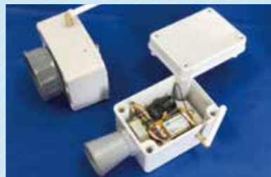
無線通信技術を活用した河川水位計
