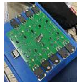
図 4：設計した MOSFET 基板（左）
