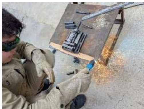
図6 曲線軌道の治具を製作する様子
