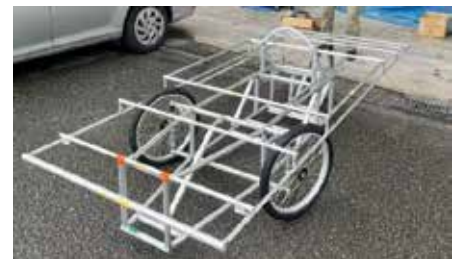
図 2-1 完成したフレーム
