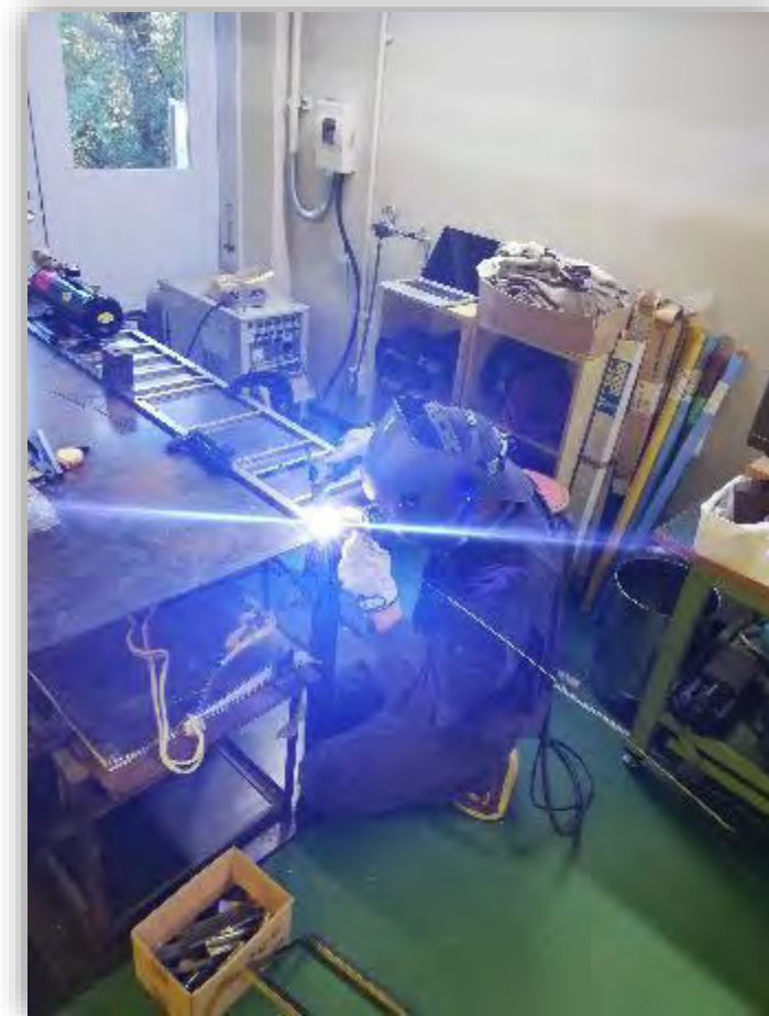
車体フレームの溶接
