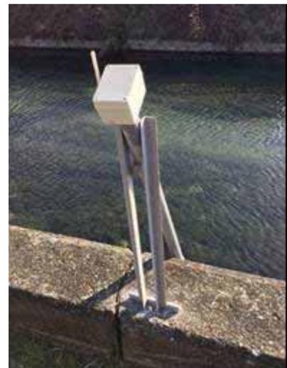
図 3 斎川に設置済の水位計
