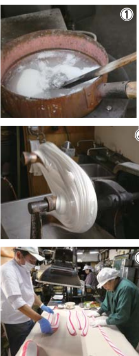
① 砂糖と水あめを中火で煮沸かす。さらに140℃の強火で加熱し水分を飛ばす
